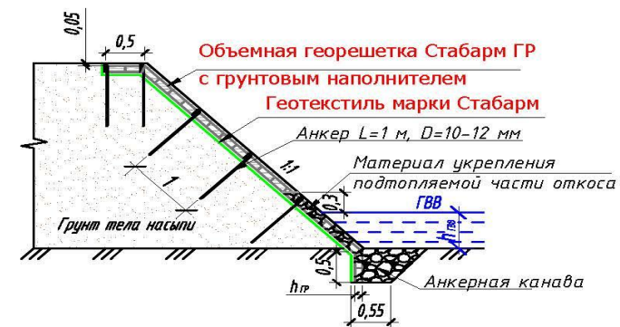
6.2.5. Конструкция неподтопляемого откоса с применением георешетки Стабарм ГР
