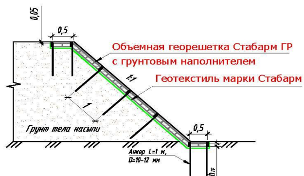
6.2.4. Конструкция неподтопляемого откоса с применением георешетки Стабарм ГР
